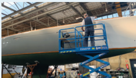
Na twee lagen primer is de eerste laklaag aan de buurt
