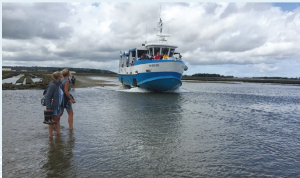
Het amfibievoertuig, bij laagwater rijden, bij hoogwater varen
