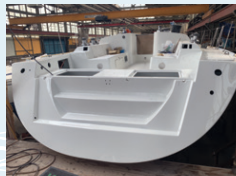
Laatste aflaklaag, eindelijk een strak resultaat
