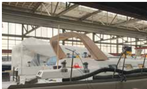
De beugel voorlopig geplaatst op het kajuitdak.
